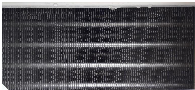
Wymiennik ciepła oczyszczony z kłaczek
